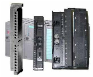
Фронтальные соединители предназначены для подключения к контроллеру внешних входных и выходных цепей. Соединитель подключается к модулю через разъем и закрывается защитной дверцей. Такая конструкция упрощает выполнение монтажных работ и позволяет производить замену модулей без демонтажа всех внешних соединений. В паз защитной дверцы устанавливается этикетка, на который наносится маркировка внешних цепей.
